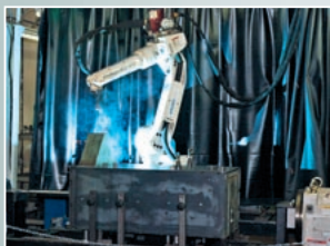
Robotizované svařovací CNC pracoviště
